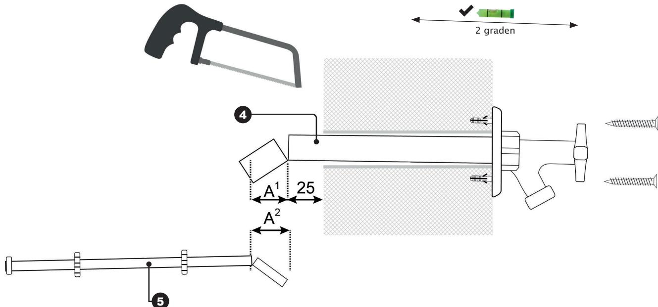
De afkortlengte (A2)\* van de spindel (5) dient exact overeen te komen met de afkortlengte (A1)\* van de koperen buis (4).
