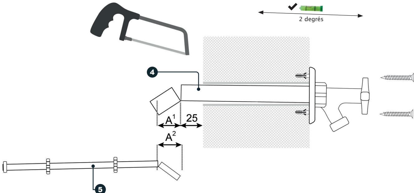
La longueur de réduction (A2)\* du tube central (5) doit correspondre exactement à celle (A1)\* du tube en cuivre (4).
