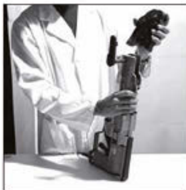
Fig. 22 - 23 In elkaar zetten van de bekken in de PRESS-tang
