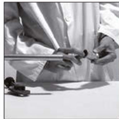
Fig. 19 Controle van de plaatsing van de o-ring
