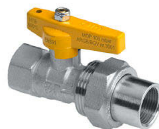
Gaskraan binnendraad x koppeling binnendraad
