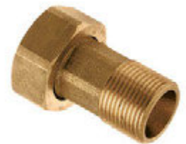
2-delige koppeling met vlakke dichting voor water konische buitendraad x wartelmoer
